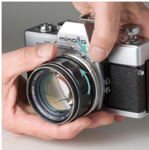
Pour monter un objectif, introduisez le dans la douille à baïonnette en alignant le point rouge placé sur le barillet de l'objectif avec le point rouge placé sur le corps de l'appareil. Tournez maintenant l'objectif dans le sens des aiguilles d'une montre jusqu'à ce qu'il s'arrête en faisant un dé clic.
