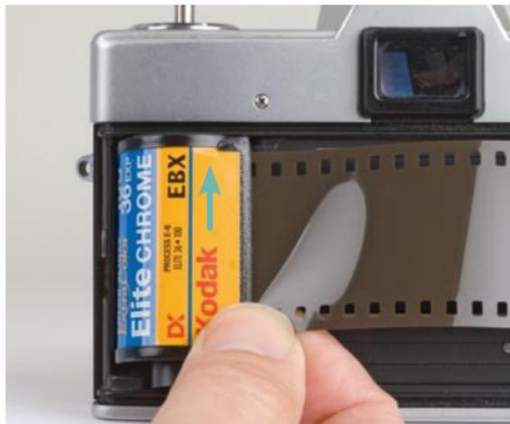
4. Faites fonctionner le levier d'avance du film jusqu'à ce que la fente de la bobine réceptrice se présente vers le haut. Faites avancer par petites poussées jusqu'à ce que les deux côtés des perforations du film soient solidement engagés sur les dents de l'axe d'entraînement. Si le levier se bloque pendant cette opération, appuyez sur le bouton de déclenchement de l'obturateur et ensuite continuez.
