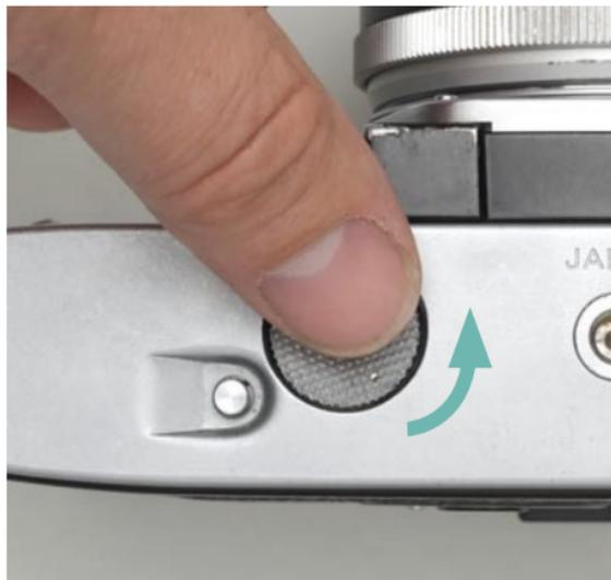
2. Enlever le couvercle du logement de la pile à l'aide de votre pouce en le tournant dans le sens contraire des aiguilles d'une montre. Quand le capuchon est enlevé, placer la pile dans son logement avec le signe + vers le haut.
