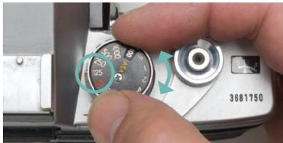
Les chiffres de B et 1 jusqu'à 1000 figurant sur le cadran de vitesses d'obturation indiquent les vitesses de 1 à 1/1000e de sec. (Sur « B » l'obturateur restera ouvert indéfiniment jusqu'à relâchement de la pression sur le bouton de déclenchement) .
